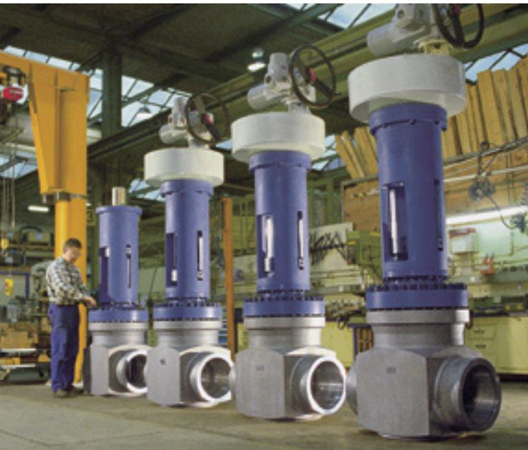
Große, blockgeschmiedete Absperrschieber aus Pegnitz zum Einsatz in Kraftwerken
