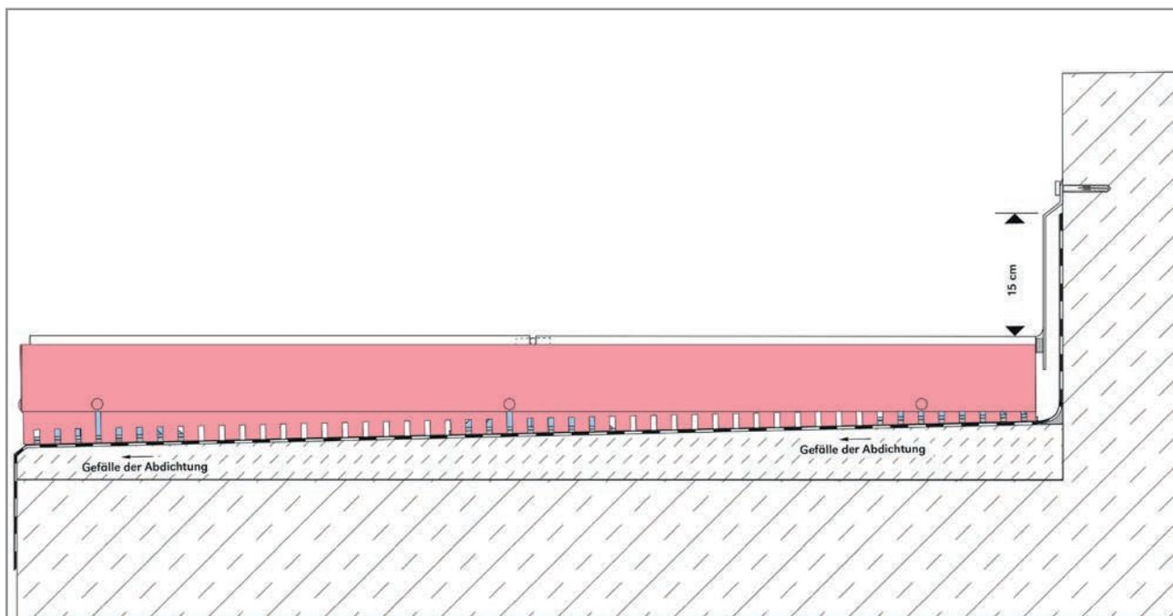
Bei offenfugigen Belägen wird oft nur ein geringes Oberflächengefälle ausgebildet. Denn die Entwässerung soll hauptsächlich über die offenen Fugen erfolgen. Die Folge ist, dass Abdichtungs- und Belagsgefälle nicht einheitlich sind – bei freien Belagsrändern entsteht dadurch ein seitlicher Keil. Die Drain-Kiesleisten ProFin KL-H sind hier die perfekte Lösung
